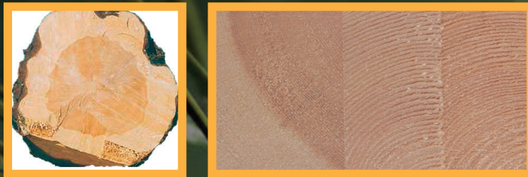
Tverrsnitt av en trestamme på et Nordvestvindu emne med de to ytre lamellene i kjerneved
